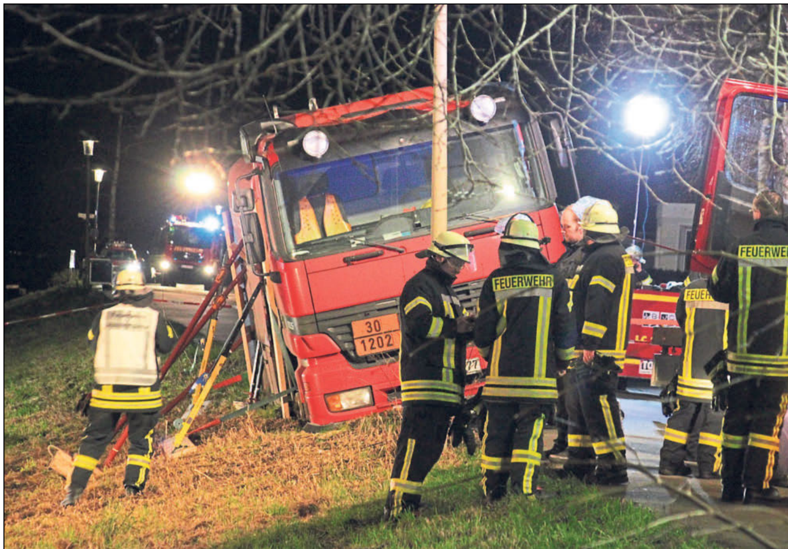
Stangen stützen den Tankwagen vor dem Abrutschen am Hang zur Flutmulde ab. Auf der anderen Seite sichern Spannurte, die an einem geparkten Anhänger befestigt wurden, das mit Heizöl beladene Fahrzeug, Keile stützen es unter den Rädern ab. Foto: Lydia Böhne
